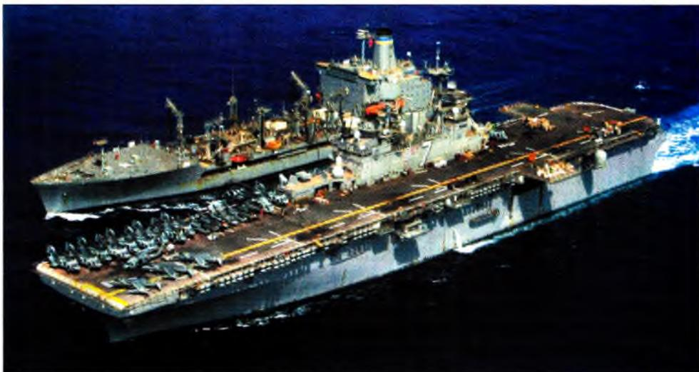
*Танкер-заправщик «Биг Хорн» (Т-АО-198) производит передачу топлива в море на ходу на УДК «Иводзима» (LHD-7)*
