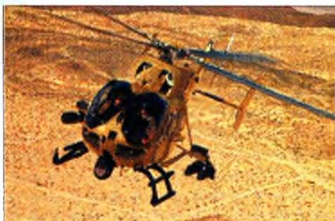
Технические характеристики AAS-72X не уточняются. Согласно требованиям военных новый вертолет должен иметь статический потолок 1 800 м при температуре окружающего воздуха выше 35 °С и массе полезной нагрузки 1 т. Этими машинами армия США намерена заменить OH-58 «Кайова».
