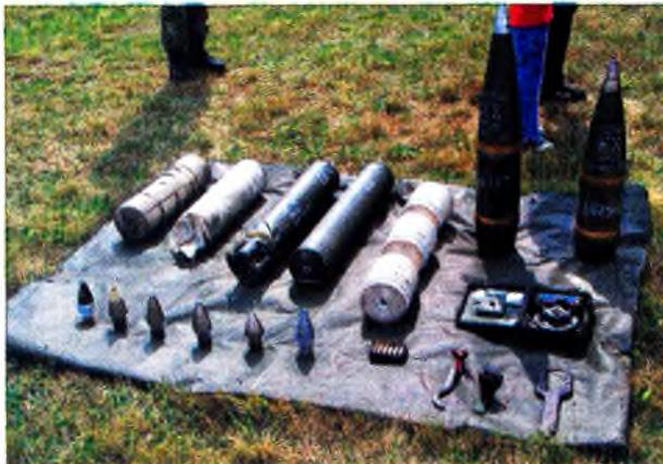
*155-мм боеприпасы, взрыватели и метательные заряды самоходной гаубицы PzH-2000*
