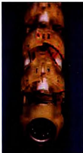
В последующем разработчики планируют снизить массу наполовину, применив прочные композиционные материалы. При действиях внутри здания робот-змея может расставлять средства наблюдения одноразового действия или заряды взрывчатого вещества в нужном месте, обеспечивая таким образом подразделениям ситуационную осведомленность, а также безопасность после срабатывания взрывного устройства и нейтрализации противника.
